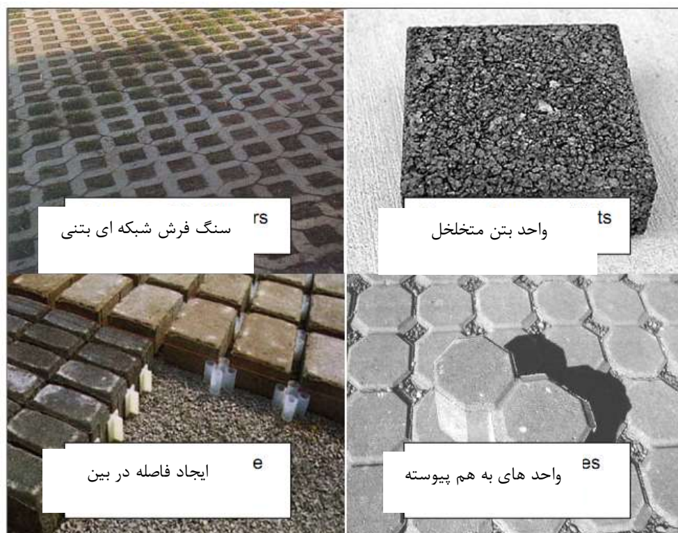
شکل ۳: انواع سنگ فرش های بتنی متخلخل
